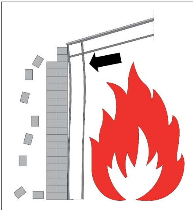
Abb. 6b: ... mit brandschutztechnisch ungeschützten Tragteilen vor allem für die Aussteifung einer Brandwand gefährlich werden kann. Figure 6b: ... with structural parts without fire protection, it can become hazardous especially for the bracing of a fire wall.
